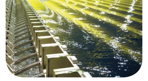
modelos reduzidos para avaliar que tipo de estrutura se comportará melhor ante a ação das ondas, correntes e ventos.
