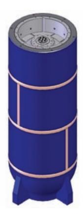
câmara, com as mesmas características, mas capaz de receber equipamentos de grande porte: terá 2,5 metros de diâmetro interno, 7 metros de comprimento e 200 toneladas de peso, podendo simular profundidades de até 7,5 mil metros (ilustração à esquerda).
