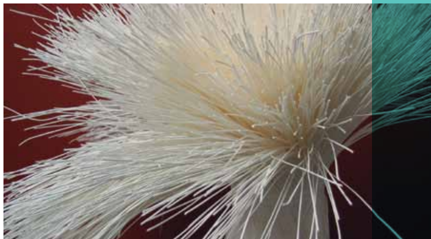
Membranas de fibra oca utilizadas no processo de microfiltração são produzidas pela PAM-Membranas, empresa originada na Coppe
