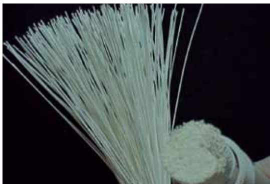
Membranas de fibra oca utilizadas no processo de microfiltração são produzidas pela PAM-Membranas, empresa originada na Coppe
